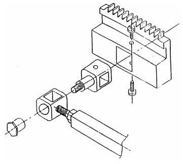
图 7 齿条与构件以转动副相联
