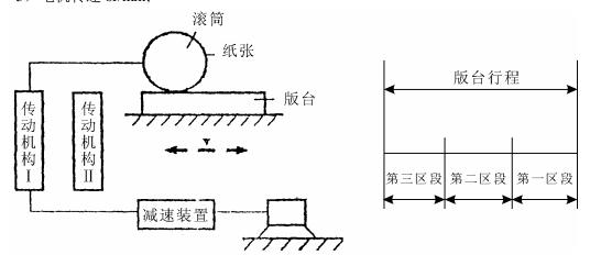
图 12 平台印刷机工作原理
