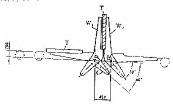
图 11 钢板翻转机构工作原理图
